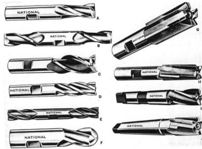
Gambar 2. 16 Pisau Jari ( End Mill Cutter ) a. Dua Mata Satu Ujung, b. Dua Mata Dua Ujung, c. Tiga Mata Satu Ujung, d. Mata Ganda Satu Ujung, e. Empat Mata Dua Ujung, f. Dua Mata Ujung Bulat, g. Tipe Carbide , h. Tipe Carbide Gigi Helik Kanan, i. Mata Potong
