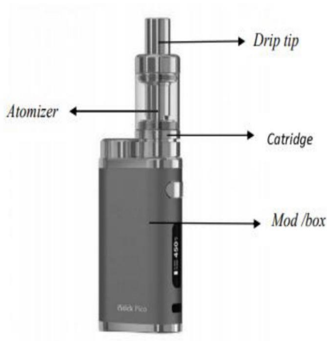
Gambar 2.2 Struktur Rokok Elektrik
