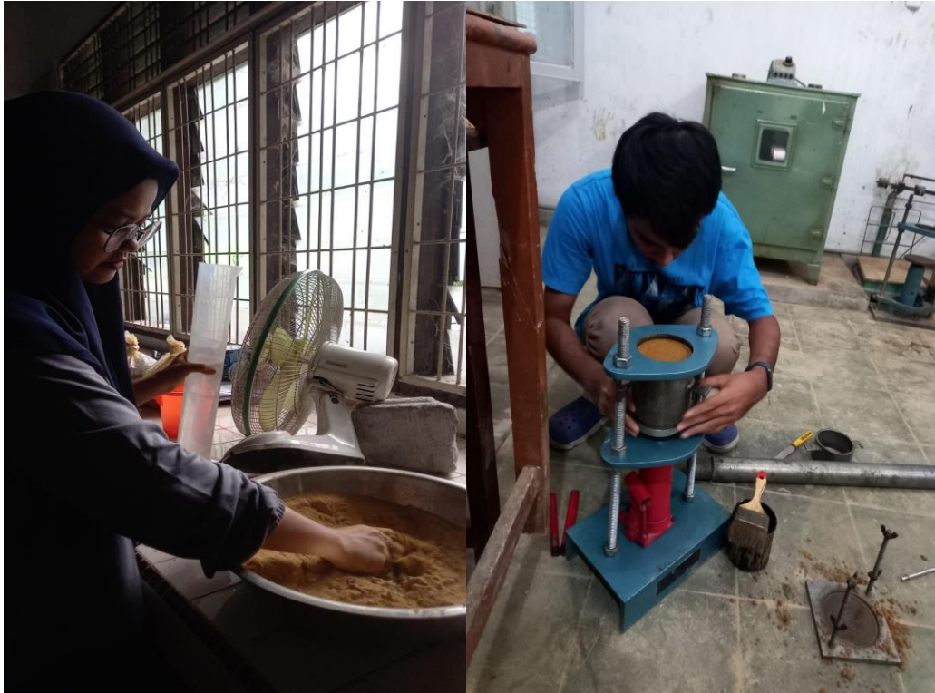
Foto dokumentasi penambahan air dan pengeluaran sampel pemadatan
