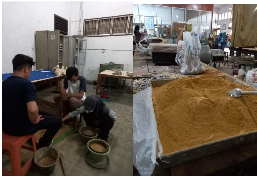
Foto dokumentasi penyaringan sampel dengan saringan No.4 dan No.40
