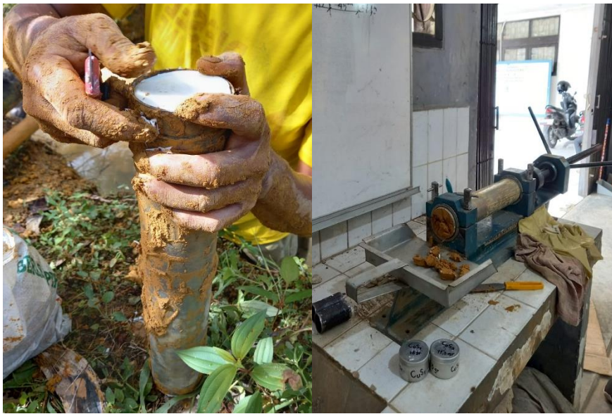
Foto dokumentasi pengambilan dan proses pengeluaran sampel undisturb
