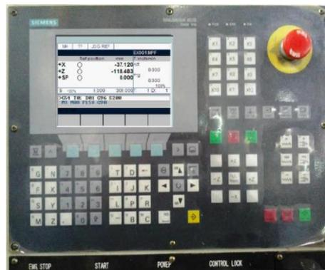
Gambar 2. 5 Bagian Kontrol dan Tampilan Program Mesin Bubut CNC.
