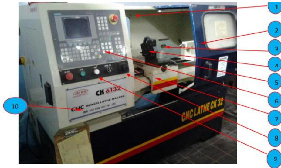
Gambar 2. 3 Bagian-bagian Mesin Bubut CNC.
