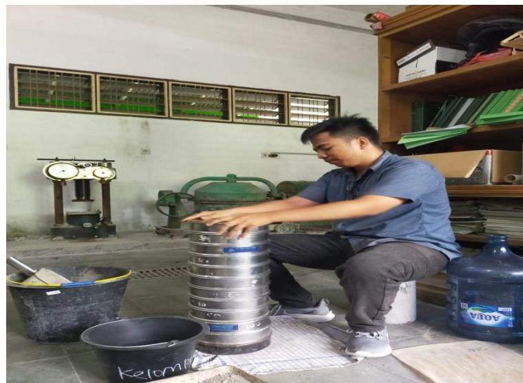
Gambar Proses Pengayakan Cangkang,Kerikil,Pasir
