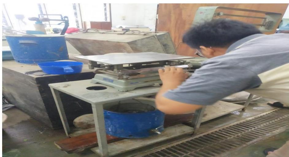
Gambar Proses Penimbangan Dalam Air
