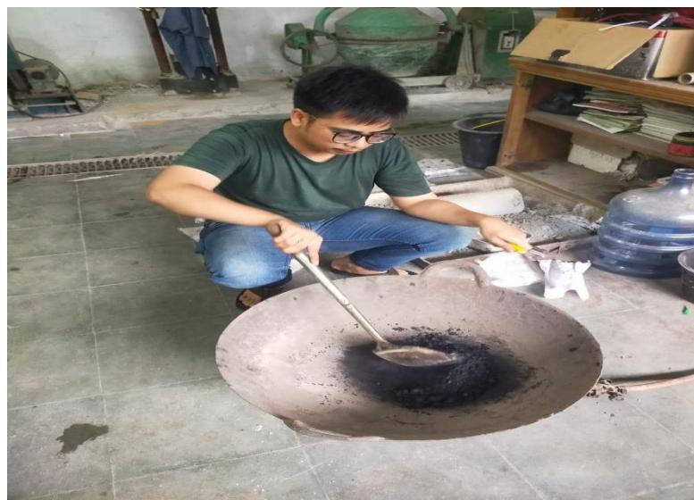
Gambar Percampuran Benda Uji Sebelum Dicetak
