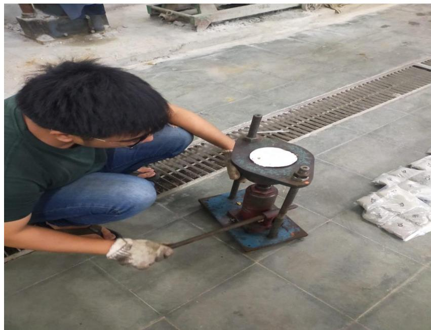
Gambar Membuka Benda Uji Dari Cetakan
