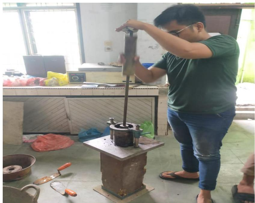
Gambar Pencetakan Benda Uji
