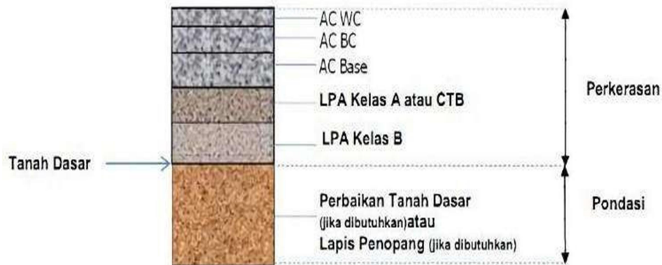
Gambar 2.3 Susunan Lapisan Aspal Beton
