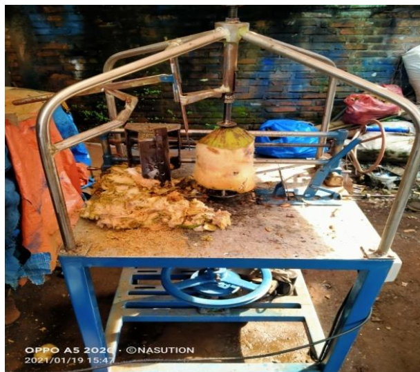
Mesin Pemisah Daging Buah Kelapa Muda Pada Saat Penyayatan Kulit Kelapa Muda
