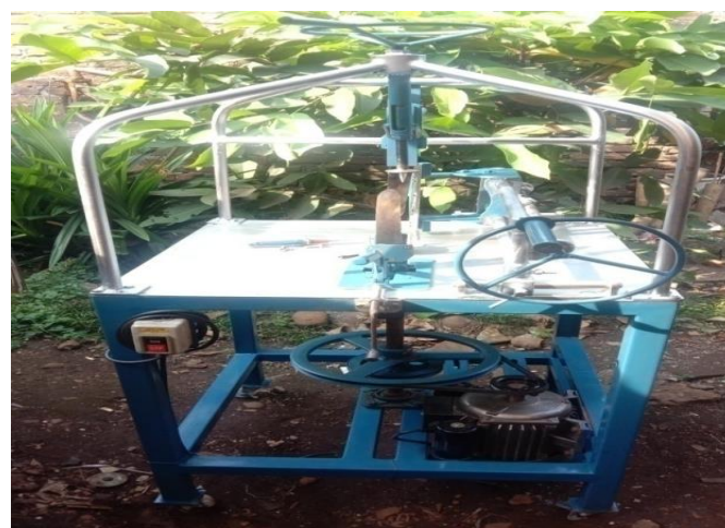
Mesin Pemisah Daging Buah Kelapa Muda Pada Saat Beroperasi Kurang Optimal
