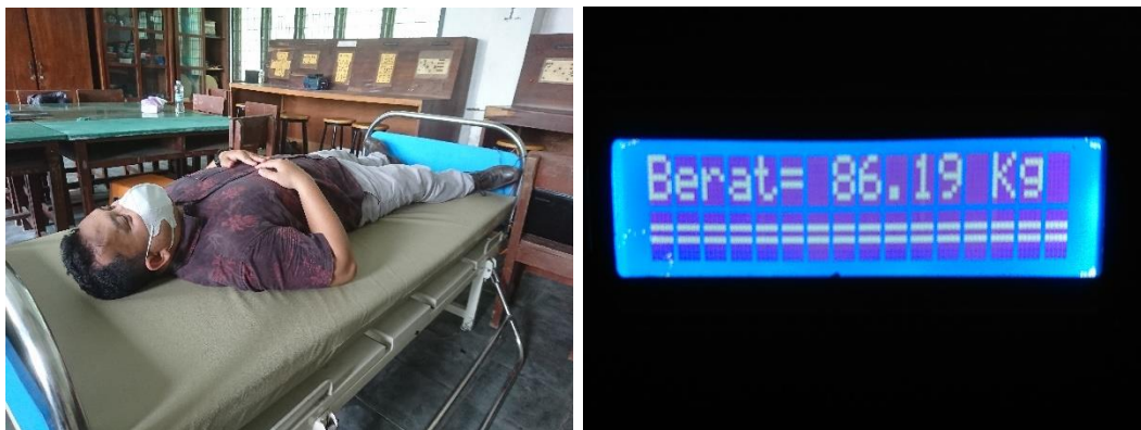
Gambar 6. Pengujian Sampel 3 dengan Smart Hospital Bed
