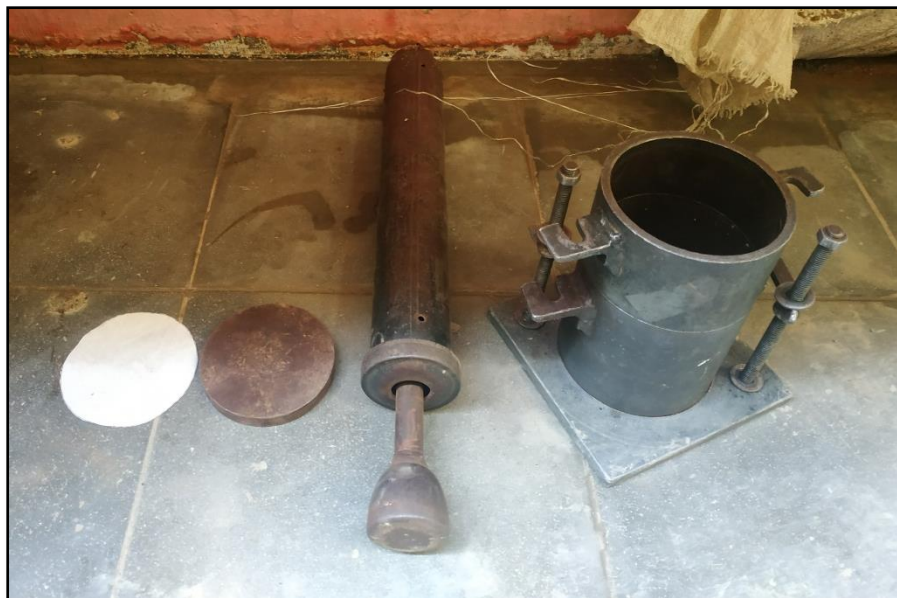
Gambar 6. Alat pengujian pemadatan ( compaction )
