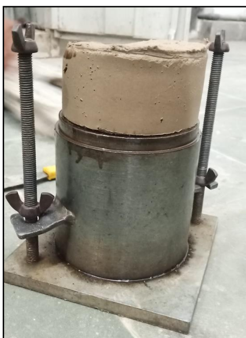
Gambar 4. Hasil pengujian pepadatan
