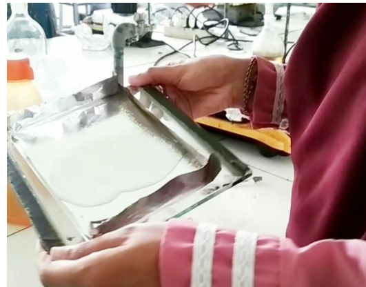
Gambar 5. Proses Pencetakan Edible Film Pulp Kakao
