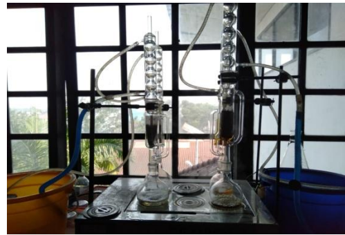
d. Proses pembuatan ekstrak di soxhlet
