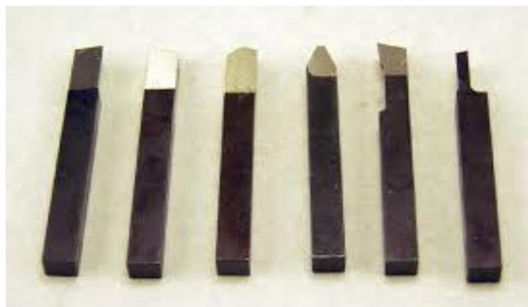
Gambar 2.7. Berbagai Jenis Pahat High Speed Steel (HSS)
