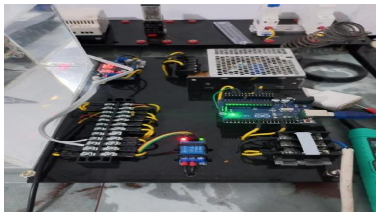
Lampiran 6 : relay kembali hidup saat suhu air di bawah 32°c
