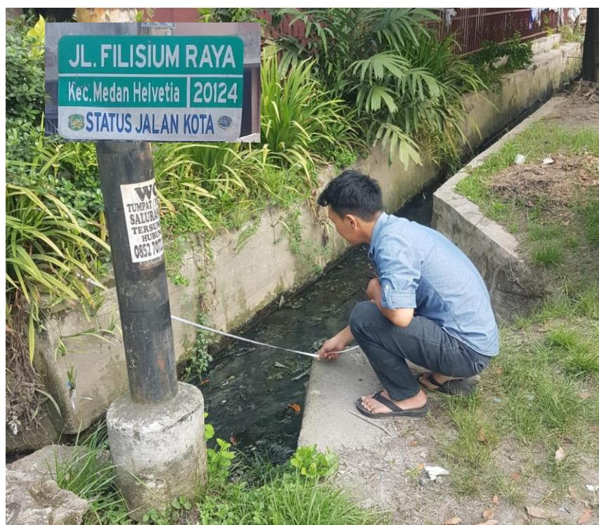
Gambar 9 : Pengukuran Drainase Sekunder Jl.Filisium Raya
