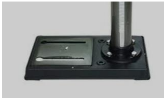
Gambar 2.1 Bagian Duduk Atau Base Mesin Bor Duduk.
