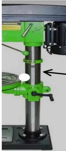
Gambar 2.2 Bagian Column Atau Tiang Bor Mesin Duduk.
