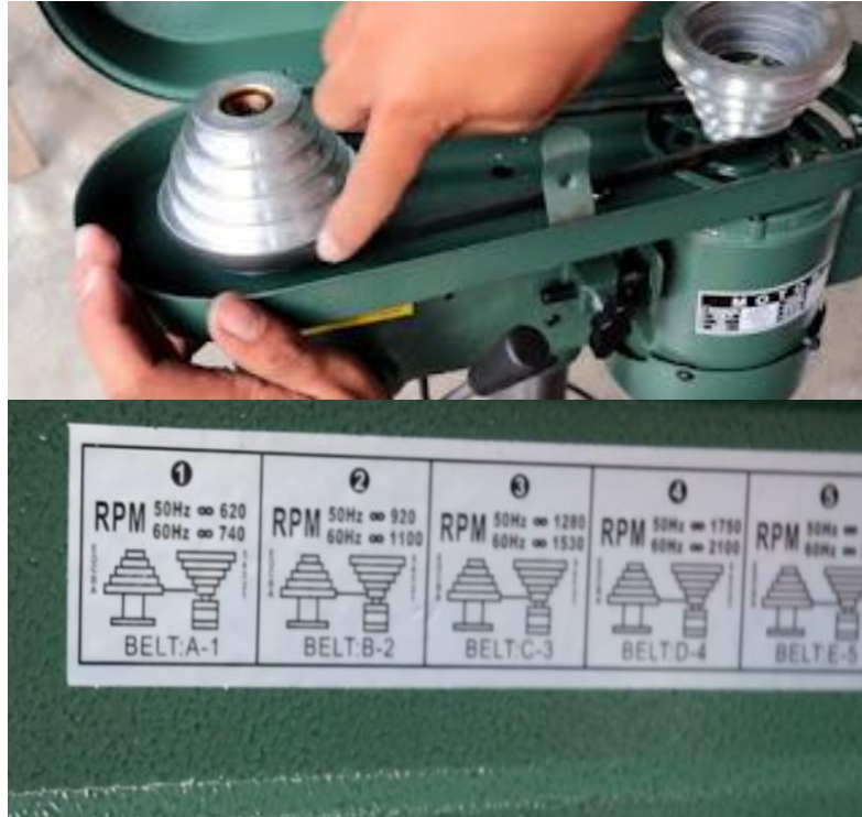
Gambar 2.7 Bagian Motor Listrik Dan Hitungan Percepatan Sesuai Rum.
