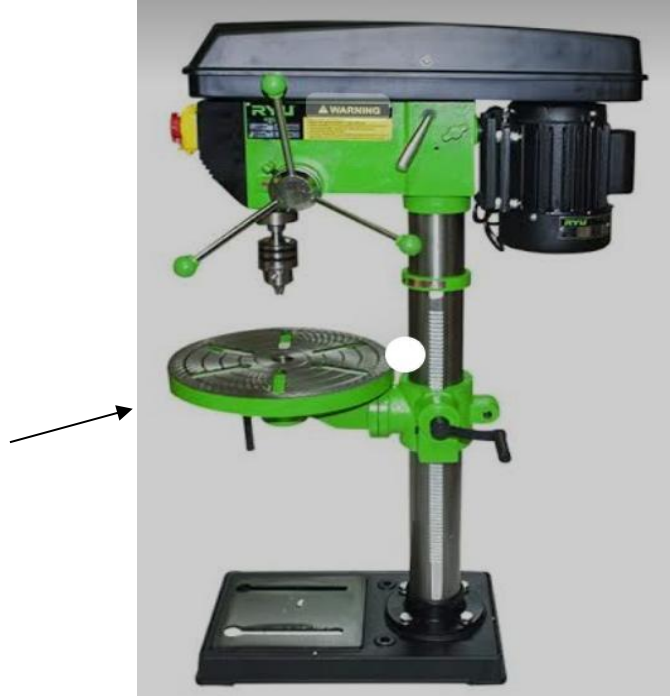
Gambar 2.3 Bagian Table Atau Meja Mesin Bor Duduk.
