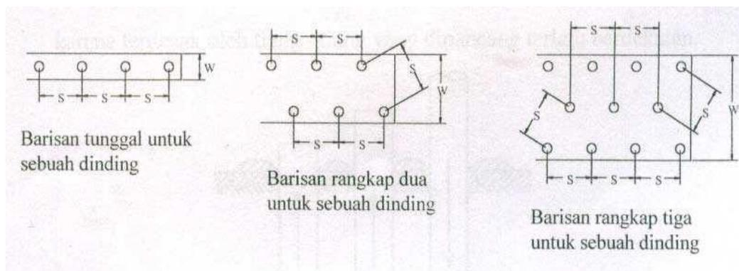
Gambar 2.17 Pola-pola Kelompok Tiang Pancang Untuk Dinding Pondasi.
