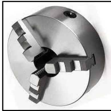
Gambar 2.10 Cekam ( Chuck ) Rahang Tiga Sepusat
