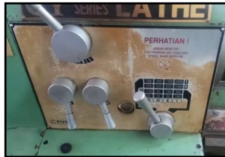
Gambar 2.8 Tuas Pengatur Kecepatan / Handle
