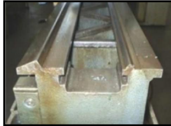
Gambar 2.4 Meja Mesin (bed)
