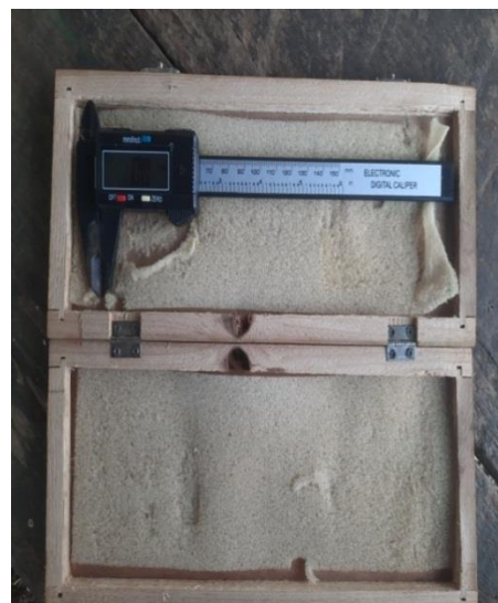
Alat Jangka Sorong digital untuk mengukur diameter batang
